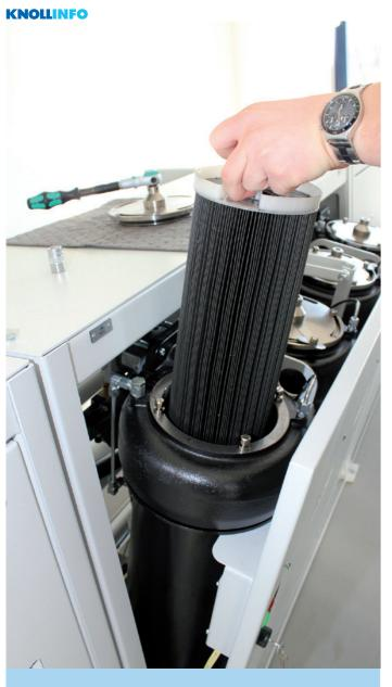
Un elemento chiave dei filtri finissimi di KNOLL del tipo Micro-Pur® è la cartuccia filtrante, che durante il processo regolarmente viene lavata in controcorrente. In caso di usura è facilissimo sostituirle rapidamente.
