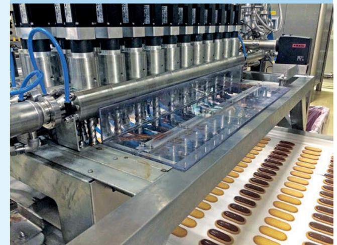
Um Crèmes und Füllungen grammgenau dosieren zu können, nutzt WPI MX-Exzentrerschneckenpumpen von KNOLL, die mit Servogetriebemotoren angesteuert werden.
