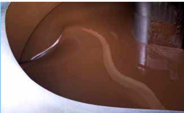
Bevor die Schokoladenmasse die Temperiermaschine durchläuft, wird sie in einer sogenannten Conche (vom spanischen Wort für Muschel) verflüssigt und mit weiteren Zutaten verrührt.
