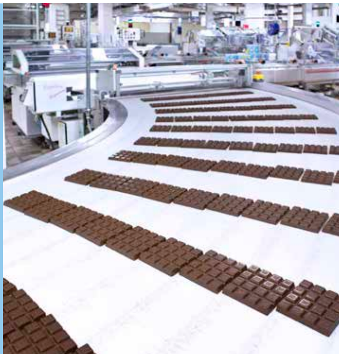
In den großen Linien produziert Ritter Sport stündlich bis zu 50.000 100g-Tafeln. Da müssen die Prozesse absolut zuverlässig funktionieren. Bilder: Ritter Sport
