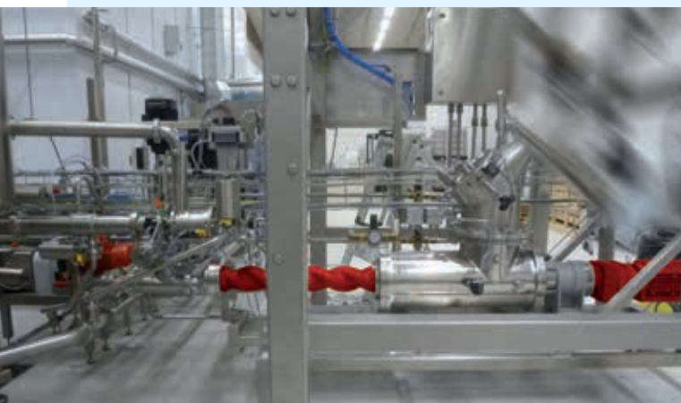
Für den Einsatz bei Isernhäger wurde die Exzentrerschneckenpumpe MX 30R individuell an die Bedürfnisse des Teigmischens angepasst. Bild: Isernhäger
