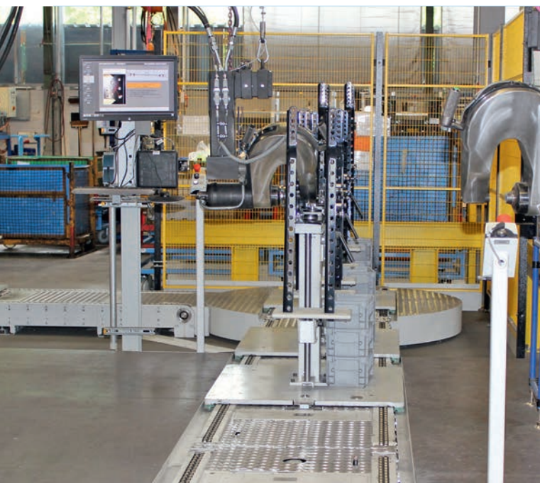
Auf den geraden Strecken wird das KNOLL Staurollen-Transportband TS-S eingesetzt.
