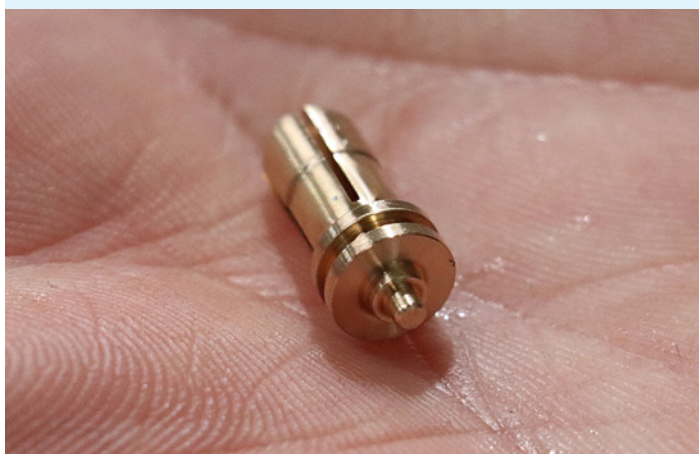
Cette pièce tournée comporte deux rainures. L'usinage haute pression rend superflu l'ébavurage habituellement nécessaire.
