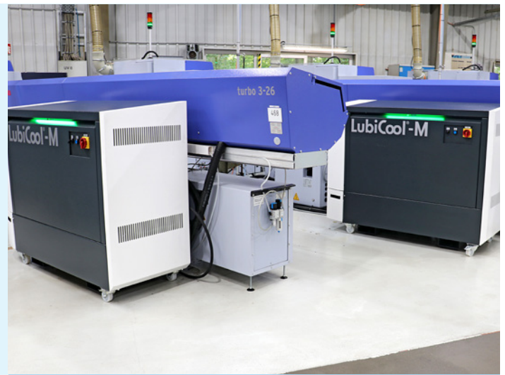
Sie sind die Lieblinge der Feindreh-Zerspaner: die beiden KNOLL LubiCool®-M-Anlagen, die SR-20 Langdrehautomaten von Star Micronics bedarfsgerecht mit KSS versorgen.
