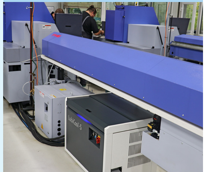
Die KNOLL Hochdruckstation LubiCool®-S findet unter dem Stangenlager Platz.
