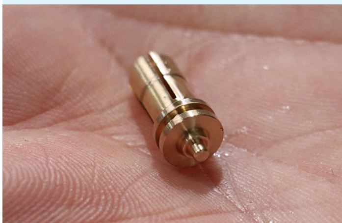
Dieses Drehteil ist zweifach geschlitzt. Bei der Hochdruckbearbeitung entfällt das sonst notwendige Entgraten.
