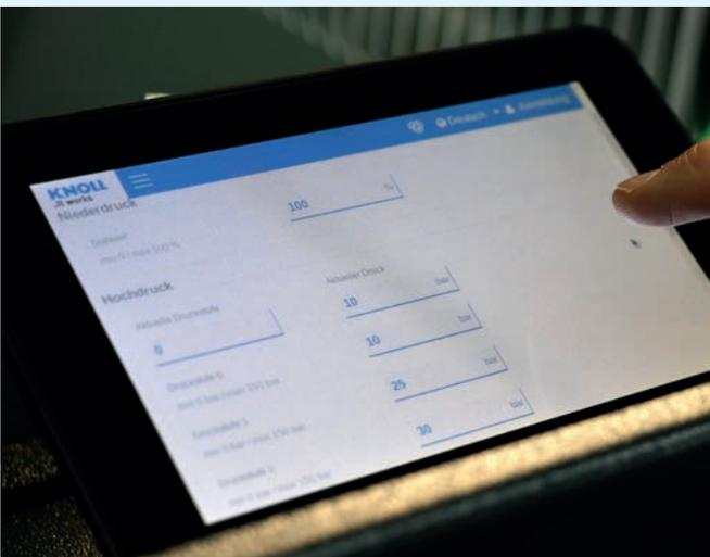
Tramite il pannello di comando SmartConnect l'utente può scegliere il livello di pressione in modo semplice e rapido.
