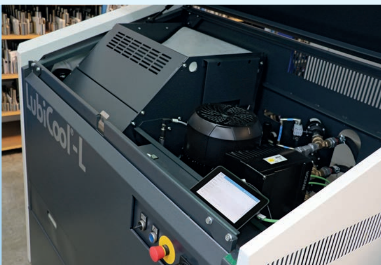
Grâce au nouveau concept de commande KNOLL SmartConnect, la commande de la LubiCool®-L est à la fois simple et intuitive. Le panneau de commande de 7" se trouve sous le capot (habituellement fermé).
