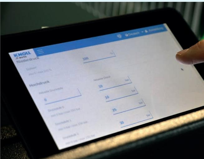
Über das SmartConnect-Bedienfeld kann der Bediener die Druckstufe einfach und schnell auswählen.
