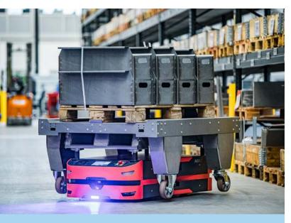
Presso la KNOLL Maschinenbau di Bad Saulgau, gran parte degli ordini di trasporto sono ora automatizzati. Gli AGV SAFELOG, che si occupano del trasporto dei vari componenti dalla produzione al magazzino e portano i componenti raccolti e pronti nel magazzino direttamente nella scatola di montaggio o alla linea di montaggio, svolgono un ruolo importante.
