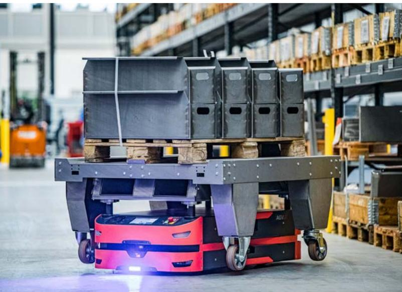
Chez KNOLL Maschinenbau à Bad Saulgau, une grande partie des ordres de transports sont désormais exécutés de façon automatisée. Les AGV de SAFELOG qui transportent diverses pièces de la production à l'entrepôt, ou des composants préparés en entrepôt directement jusqu'à la boîte de montage ou au tapis de montage y contribuent grandement.
