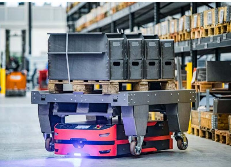
En la planta de KNOLL Maschinenbau de Bad Saulgau, gran parte de las tareas de transporte ya tienen lugar de forma automatizada. Un porcentaje importante son AGV de SAFELOG que transportan diversos componentes desde la producción hasta el almacén, y llevan componentes preparados en almacén a la caja de montaje o a la cinta de montaje.
