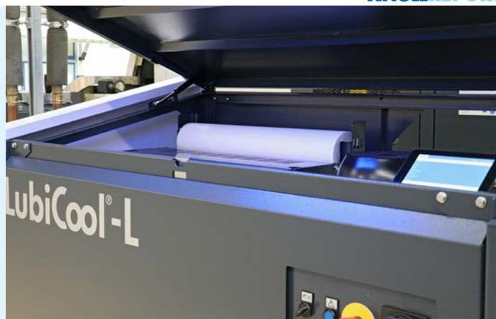
TROKAMED a fait installer la nouvelle station haute pression LubiCool®-L sur un grand centre de tournage-fraisage. Sous le couvercle se cachent, outre la pompe puissante, un filtre à bande efficace et le pavé tactile du système de commande convivial.
