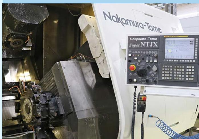
Sur le centre de tournage-fraisage Nakamura Super NTJX, TROKAMED fabrique des composants complexes à symétrie de rotation pour les instruments médicaux ainsi que des pièces spéciales de mécanique de précision. Une alimentation haute pression en lubrifiant réfrigérant purifié est ici indispensable.
