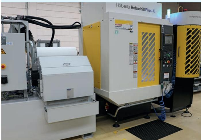
Pour les centres de fraiseuse qui ont besoin d'un plus grand volume de lubrifiant réfrigérant, KNOLL propose un système haute pression ouvert avec une plus grande capacité de filtre et de réservoir. TROKAMED a fait équiper de ce système le RobodrillPlus-K automatisé de Häberle, livré tout récemment.
