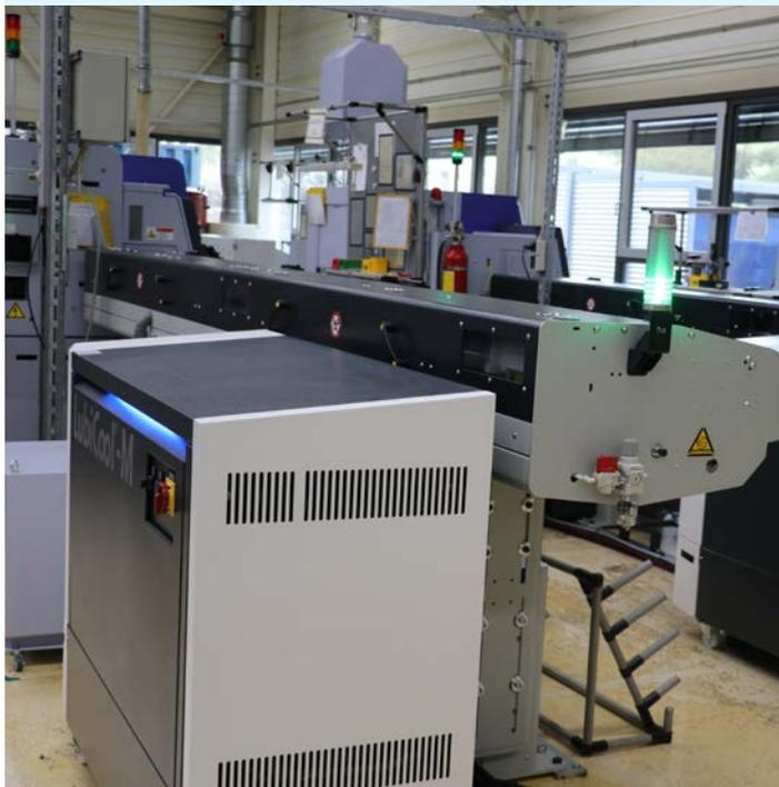
Les appareils LubiCool@-M alimentent les deux tours automatiques à poupée mobile SP-23 et SV-20R de Star Micronics en lubrifiant réfrigérant selon les besoins.
