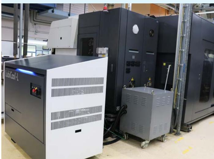
Le nouveau LubiCool®-L de KNOLL (à gauche devant) a pu être installé facilement sur le centre de tournage-fraisage Nakamura.
