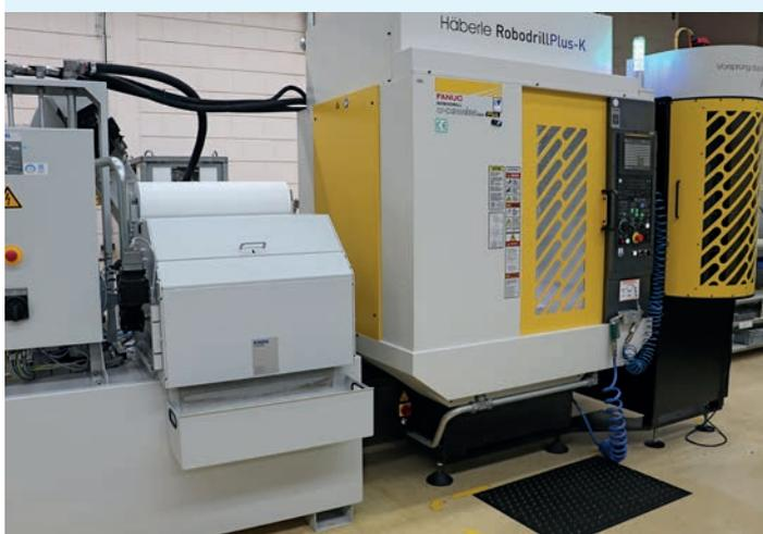
Para los centros de fresado que requieren un mayor volumen de refrigerante, KNOLL ofrece un sistema abierto de alta presión con mayor capacidad de filtrado y depósito. TROKAMED la equipó con la RobodrilPlus-K automatizada de Häberle recientemente suministrada.
