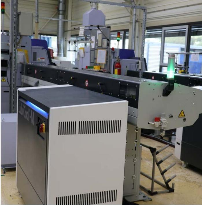
Los dispositivos LubiCool®-M suministran refrigerante según las necesidades a las dos máquinas automáticas de torneado longitudinal SP-23 y SV-20R de Star Micronics.
