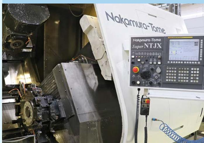
TROKAMED utiliza el centro de torneado y fresado Nakamura Super NTJX para fabricar componentes complejos con simetría rotacional para instrumentos médicos y piezas especiales de ingeniería de precisión. En este caso es esencial un suministro a alta presión de lubricante refrigerante purificado.
