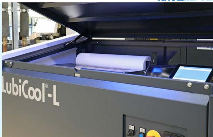
TROKAMED ha instalado la nueva estación de alta presión LubiCool®-L en un gran centro de torneado y fresado. Además de la potente bomba, la cubierta oculta un eficaz filtro de cinta y el panel táctil del sistema de control de fácil manejo.
