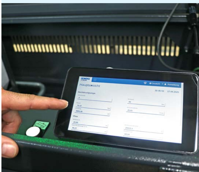
Das integrierte Touchpad ermöglicht die Überwachung und Visualisierung der wichtigsten Betriebsdaten der Anlage.
