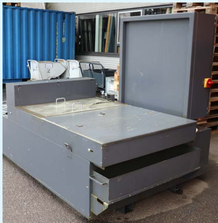
Ausgemustert: Diese Hochdruckstation mit Flachbettfilter musste dem deutlich kompakteren, leistungsstärkeren KNOLL LubiCool®-L weichen.
