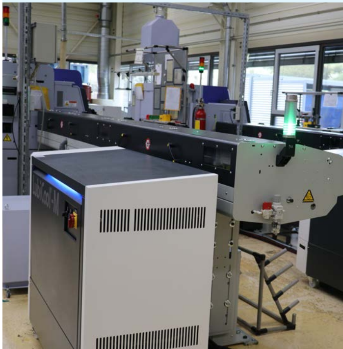
LubiCool®-M-Geräte versorgen die beiden Langdrehautomaten SP-23 und SV-20R von Star Micronics bedarfsgerecht mit KSS.
