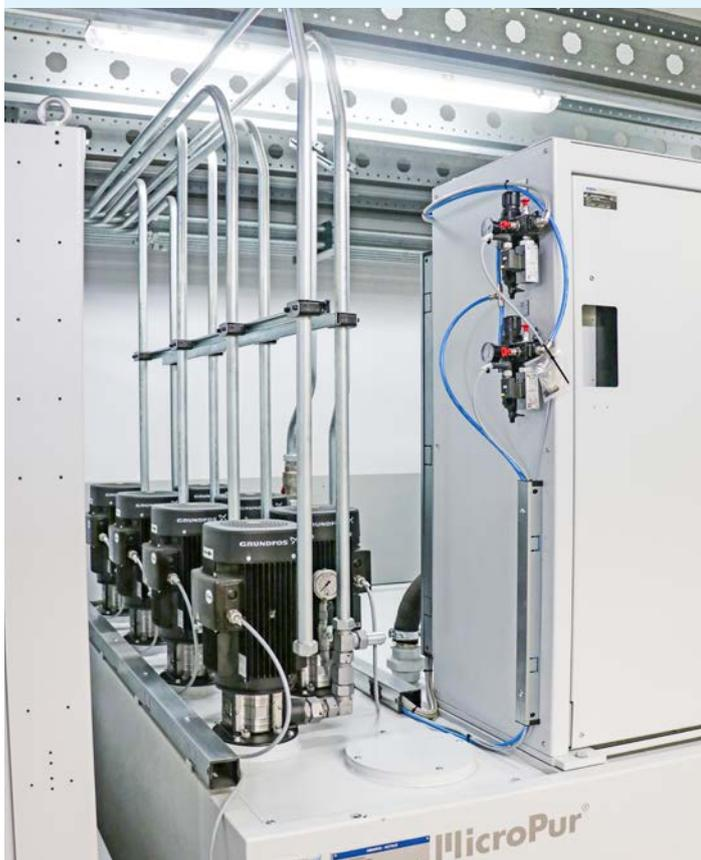
Una richiesta speciale: diversamente da sistemi centrali tradizionali presso la Schnebelt Präzision ogni macchina di rettifica è attrezzata di una pompa per l'olio puro con linea di mandata separata.
