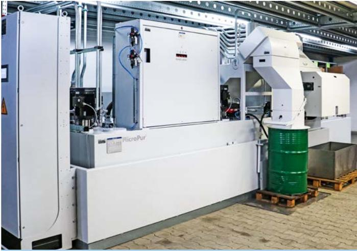
Funziona perfettamente: il sistema centrale di KNOLL presso la Schnebelt Präzision è composto da un filtro compatto KF-E (dietro), un filtro finissimo MicroPur® (in prima linea), un concentratore automatico (con botte verde) e un aggregato di raffreddamento (non rappresentato nell'immagine). Il filtro compatto (nello sfondo) provvede a un'estrazione di trucioli asciutti. Il fango di metallo duro esce dal concentratore automatico e cade nella botte verde praticamente genuino.
