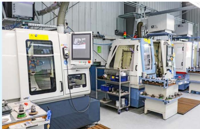
Actuellement, six affûteuses d'outils à 5 axes sont raccordées à l'installation centrale KNOLL.
