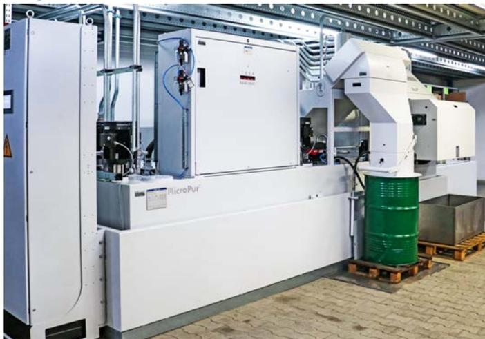
Fonctionnement sans entrave : l'installation centrale KNOLL chez Schnebelt Präzision se compose d'un filtre compact KF-E (à l'arrière), d'un filtre ultrafin MicroPur® (au premier plan), d'un concentrateur automatique (avec un tonneau vert) et d'un groupe de refroidissement (non représenté en photo). Le filtre compact (en arrière-plan) assure l'évacuation des copeaux secs. Les boues de carbure tombent dans le fût vert à partir du concentrateur automatique. Elles sont déjà en grande partie triées.
