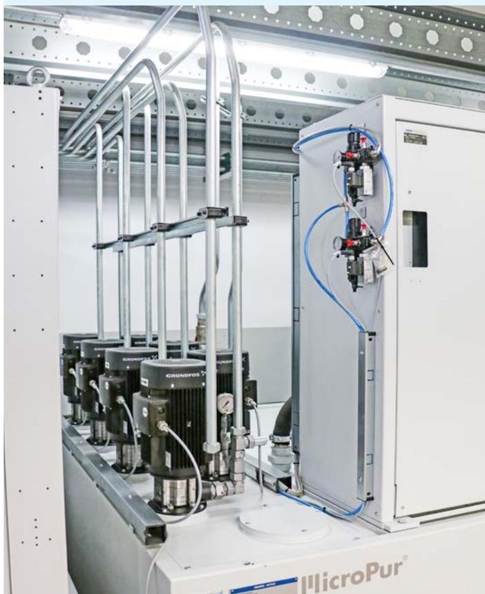
Une demande particulière : à la différence des installations centralisées classiques, Schnebelt Präzision a fait le choix d'affecter une pompe à huile pure avec conduite d'alimentation séparée à chaque rectifieuse.
