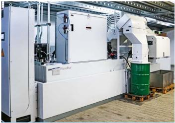
Funcionamiento perfecto: la instalación central KNOLL, en Schnebelt Präzision, está formada por un filtro compacto KF-E (atrás), un filtro de partículas ultrafinas MicroPur® (en primer plano), un concentrador automático (con el barril verde) y un grupo refrigerador (no se ve en la imagen). El filtro compacto (en segundo plano) asegura una descarga de virutas secas. El lodo de metal duro cae con un alto grado de pureza en el barril verde desde el concentrador automático.
