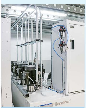
Una petición especial: a diferencia de las instalaciones centrales clásicas, en Schnebelt Präzision cada rectificadora tiene su propia bomba de aceite puro con línea de alimentación separada.
