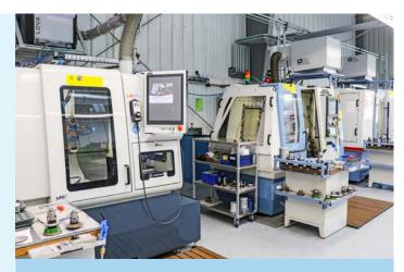
Actualmente hay seis rectificadoras de herramientas de 5 ejes conectadas a la instalación central de KNOLL.
