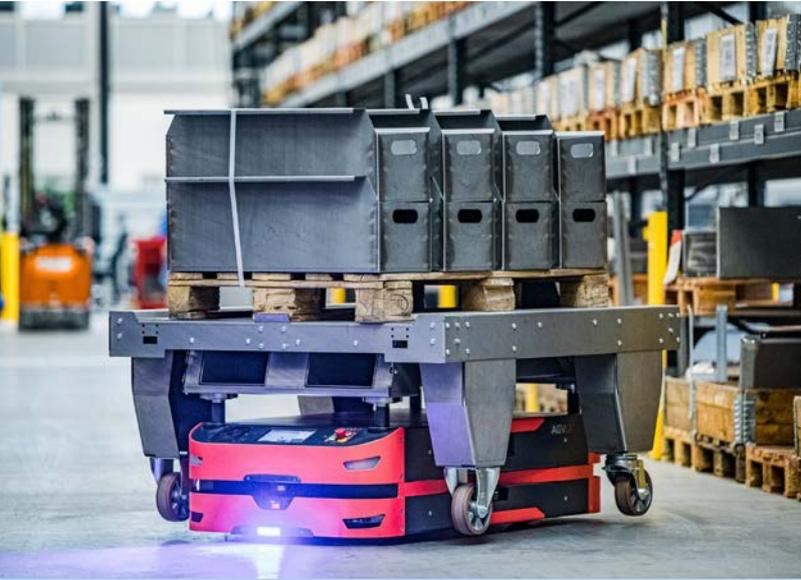
Bei KNOLL Maschinenbau in Bad Saulgau wird inzwischen ein Großteil der Transportaufträge automatisiert erledigt. Einen großen Anteil haben SAFELOG AGVs, die den Transport diverser Bauteile von der Produktion ins Lager übernehmen und kommissionierte, im Lager bereitgestellte Komponenten direkt in die Montagebox oder ans Montageband bringen.
