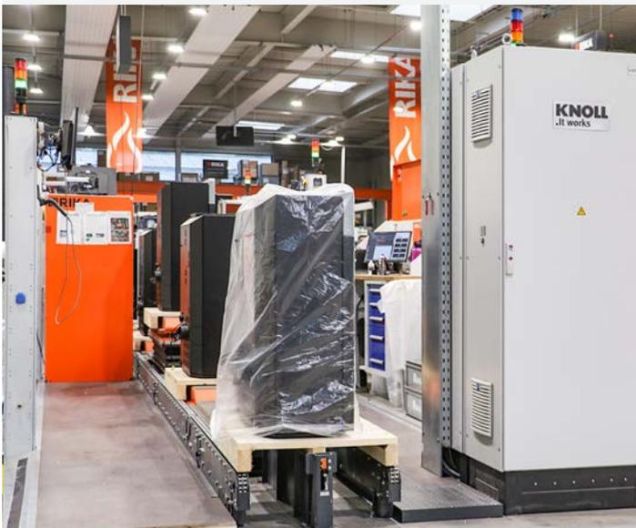
Die Montagelinie bei RIKA Innovative Ofentechnik endet an der letzten Station mit einer 100-Prozent-Kontrolle, bei der alle Komponenten eines Ofens durchgecheckt werden.
