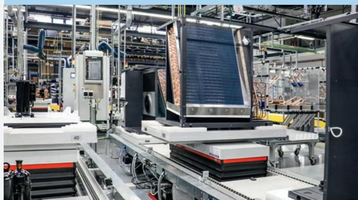
In der Montageanlage bei STIEBEL ELTRON sind die meisten Arbeitsplätze mit einem Hubtisch und Drehplattform für eine ergonomische Montage ausgestattet.
