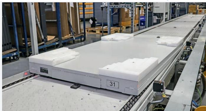
Für STIEBEL ELTRON konstruierte und lieferte KNOLL neben den Fördersystemen und Montagearbeitsplätzen auch die Trägerplatten, die mit allen Wärmepumpen-Varianten kompatibel sind.
