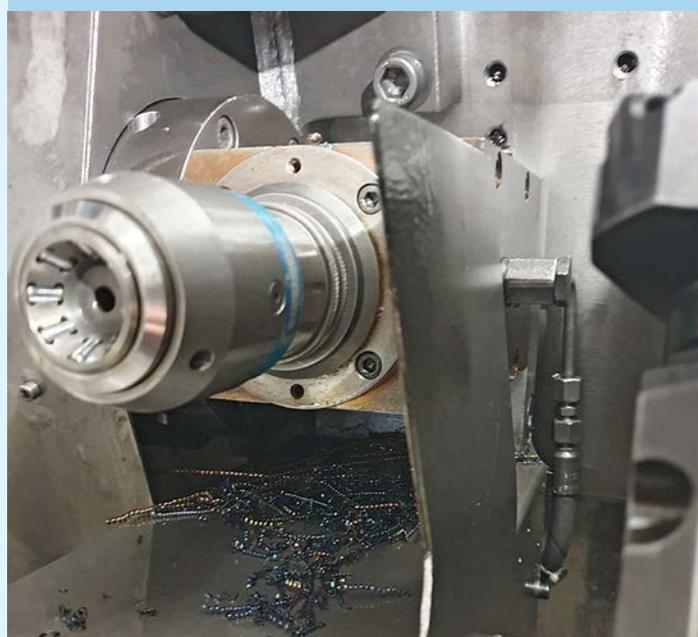
La unidad de bruñido de rodillos para los pernos esféricos también se alimenta con el sistema de lubricación en seco por aerosol de Knoll con el aerosol más fino.
