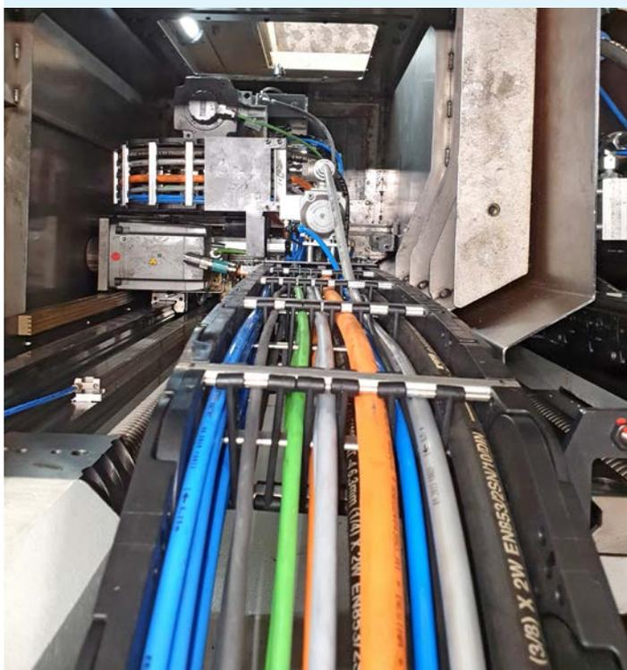
GSN instaló las conexiones para el AerosolMaster™ 4000 ATS utilizando el tendido de cables existente y se encargó de la conexión eléctrica y de control completa, incluida la documentación en el E-plan.
