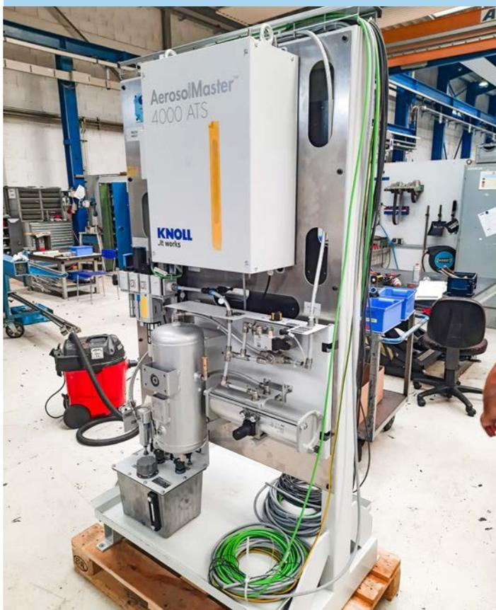
La preinstalación del AerosolMaster™ 4000 ATS, incluidos el amplificador de presión, la unidad neumática y la unidad de rellenado, ya fue llevada a cabo por GSN, al igual que la prueba funcional inicial.
