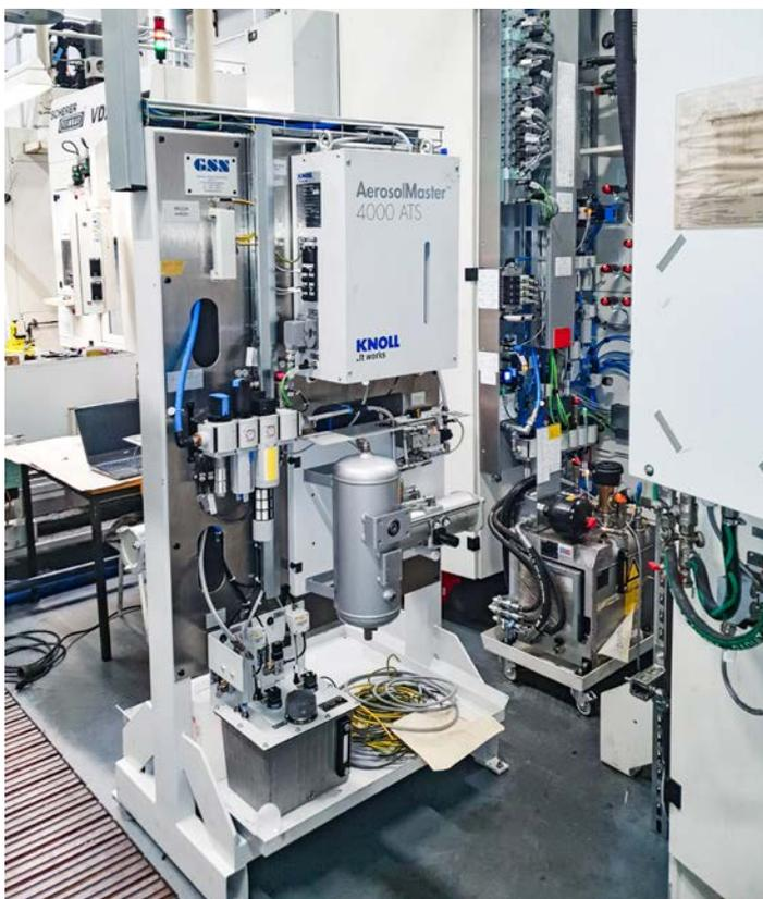
GSN reequipó 32 tornos de un fabricante de automóviles alemán de mecanizado en húmedo con la lubricación en seco por aerosol que ofrece KNOLL. La imagen muestra la disposición compacta de las unidades AerosolMaster™ 4000 ATS entre dos máquinas.
