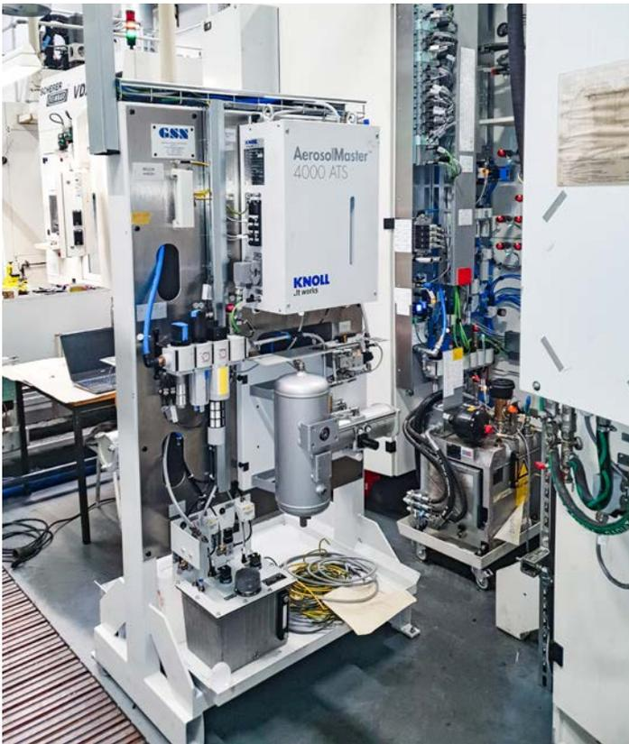
GSN rüstete bei einem deutschen Automobilhersteller 32 Drehmaschinen von Nassbearbeitung auf die von KNOLL angebotene Aerosol-Trockenschmierung um. Im Bild sieht man die platzsparende Anordnung der AerosolMaster™ 4000 ATS-Geräte zwischen jeweils zwei Maschinen
