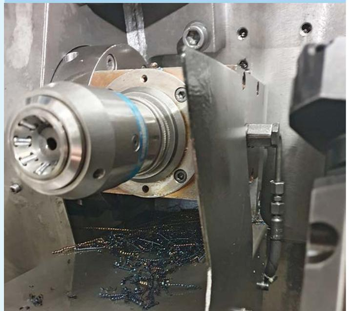
Auch die Rolliereinheit für die Kugelpapfen wird vom KNOLL ATS-System mit feinstem Aerosol versorgt.
