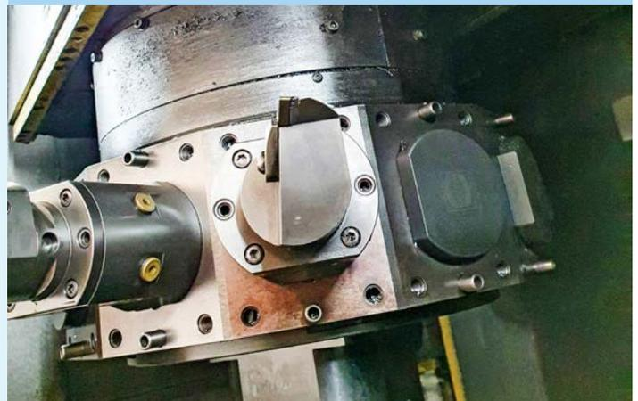
Da die Revolver der Drehzentren bereits mit innengekühlten Werkzeugen bestückt sind, war die Umstellung von KSS auf ATS problemlos möglich.
