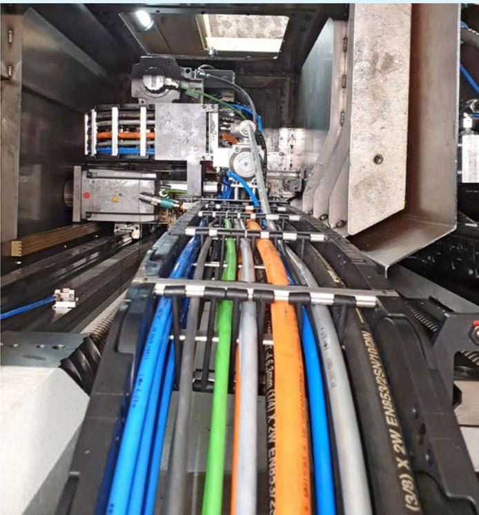
GSN verlegte die Anschlüsse des AerosolMaster™ 4000 ATS mit dem vorhandenen Kabelschlepp und übernahm die komplette elektrische und steuerungstechnische Anbindung samt Dokumentation im E-Plan.
