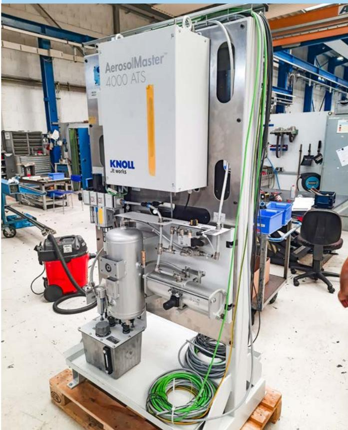
Eine Vorinstallation des AerosolMaster™ 4000 ATS samt Druckverstärker, Pneumatikeinheit und Nachfüllaggregat fand bereits bei GSN statt, ebenso die erste Funktionsüberprüfung.
