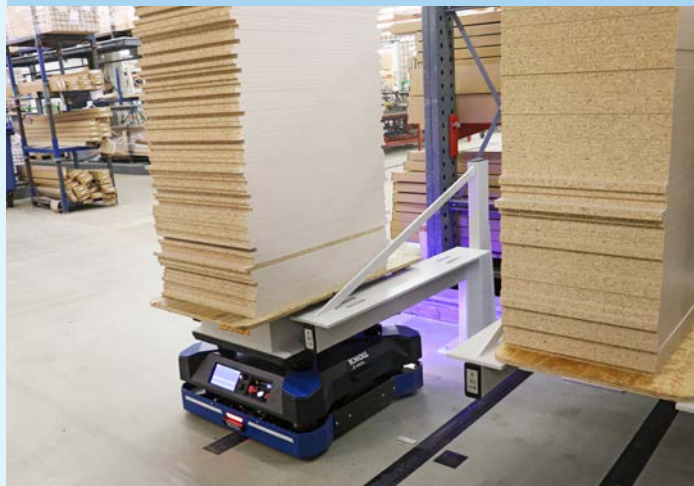
L'espace est restreint. Cela tombe bien que l'AGV puisse tourner sur place à 360 degrés et entrer ensuite très précisément dans la station tampon.
