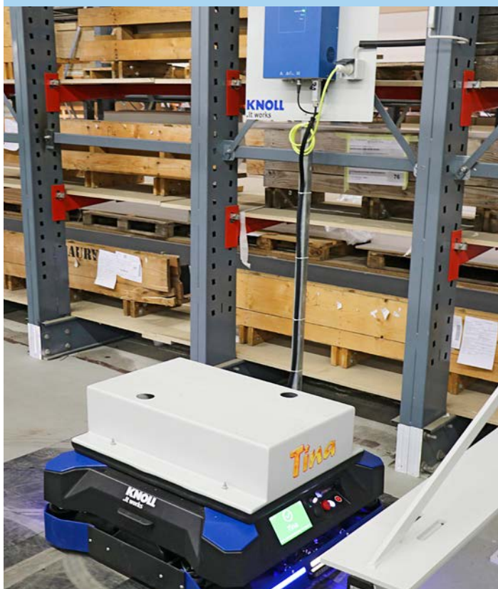
Les AGV passent les pauses dans le transport à la station de chargement.
