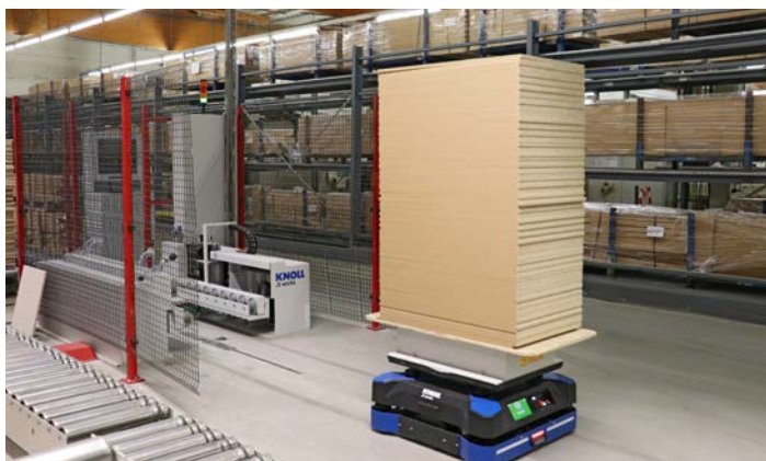
AGV Bibi en route vers la station d'accueil de la ligne des socles.
