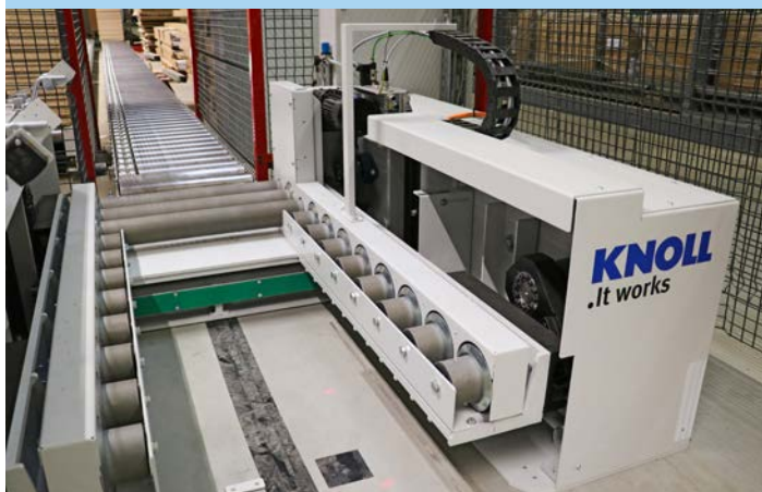
La station d'accueil de la ligne des socles se caractérise par une construction mécanique solide. Le plateau de transport est déposé sur le convoyeur à rouleaux court. Ensuite, il y a un abaissement au niveau bas de la ligne de transport existante de Staud.
