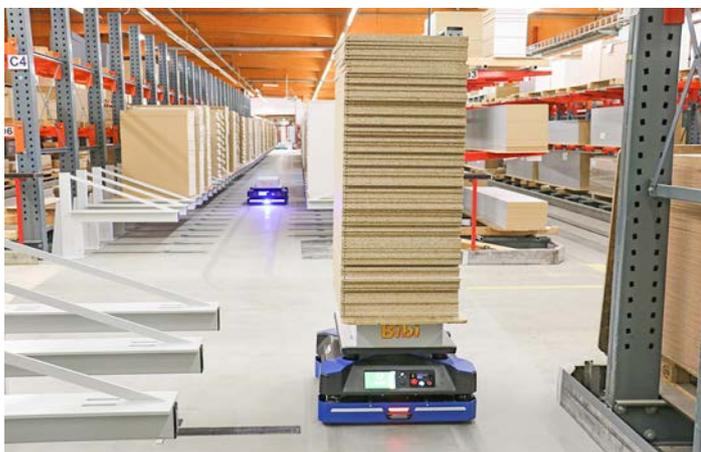
Nueva solución intralógica para el fabricante de muebles Staud: dos AGV de KNOLL, bautizados Bibi y Tina por los empleados, se encargan del transporte de tableros desde la línea de máquinas hasta las estaciones de almacenamiento intermedio y su posterior montaje en la línea del zócalo.
