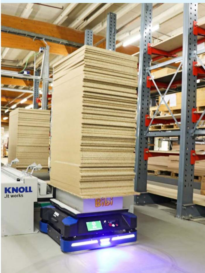
Después de colocarse, el AGV con la pila de tableros se dirige a una estación libre de almacenamiento intermedio.
