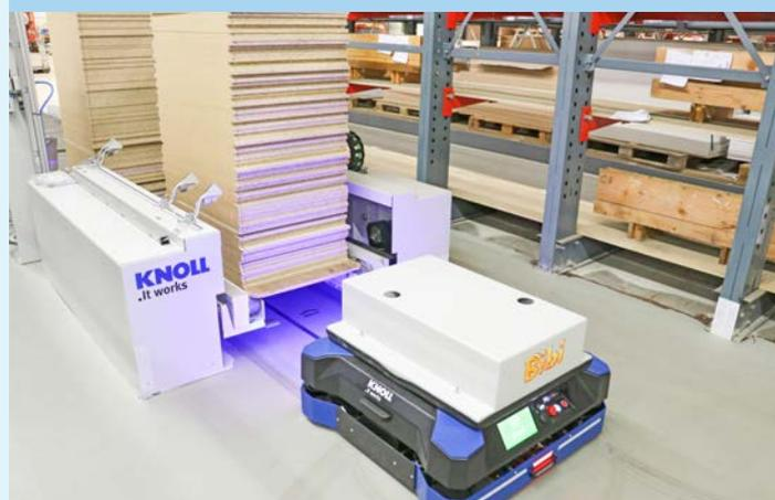
Poco antes de la transferencia al AGV, la placa de transporte se lleva a un nivel en la estación de transferencia mediante un dispositivo de elevación personalizado para el cliente para que el AGV pueda circular por debajo.
