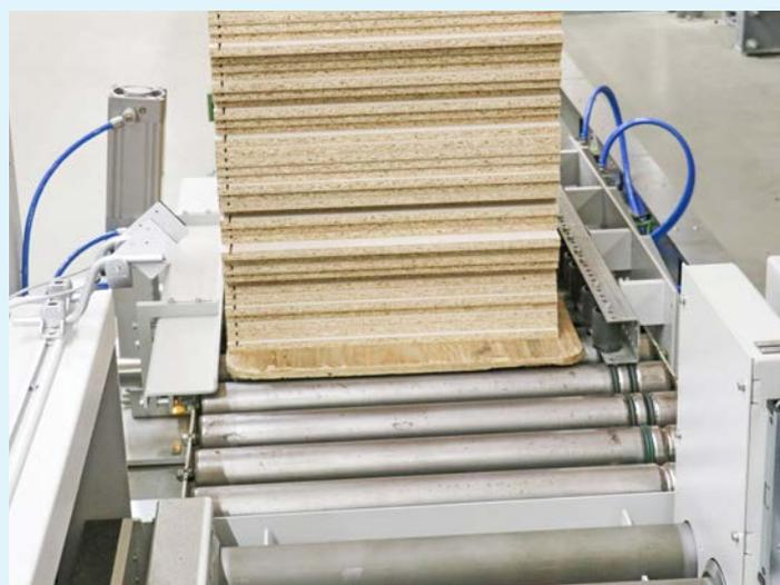
Un dispositivo especial con un sello garantiza que la placa de transporte esté correctamente alineada antes de entrar en la estación de transferencia.
