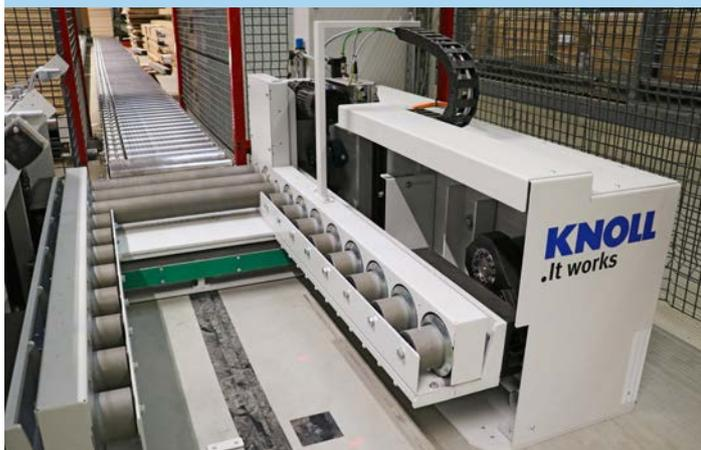
La estación de recepción de la línea del zócalo se caracteriza por una sólida ingeniería mecánica. La placa de transporte se deposita en el transportador de rodillos cortos. A continuación, se baja al nivel inferior de la línea de transporte existente de Staud.
