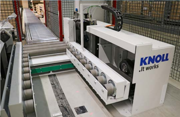
Die Aufnahme­station an der Sockelstraße zeichnet sich durch soliden Maschinenbau aus. Auf der kurzen Rollenbahn wird die Transportplatte abgesetzt. Anschließend erfolgt eine Absenkung auf das niedrige Niveau der bestehenden Transportstrecke von Staud.
