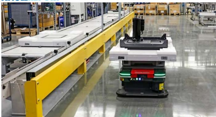
A sinistra nell'immagine: la prima linea di trasporto. Sulle due postazioni di montaggio è dapprima montata la piastra di fondo e poi il compressore del relativo modello di pompa di calore.
