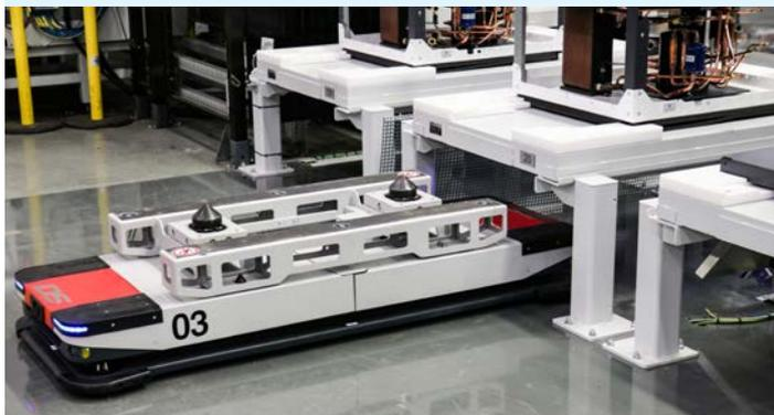
Il concatenamento di tecnica di trasporto stazionaria avviene attraverso sistemi di trasporto non equipaggiati. La gestione degli ordini per gli ordini di trasporto si svolgono in SAP ME, al quale tutti i sistemi dell'intero impianto possiedono un'interfaccia.
