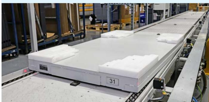
Oltre ai sistemi di trasporto e alle postazioni di montaggio, la KNOLL costruì e fornì anche le piastre di supporto che risultano compatibili con tutte le varianti di pompe di calore di STIEBEL ELTRON.
