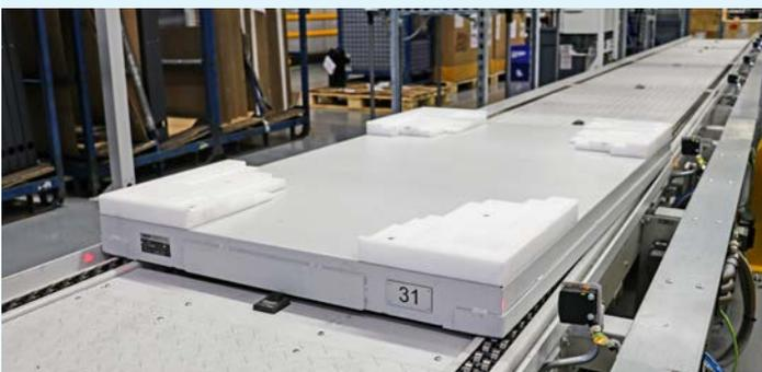
Outre les systèmes de transport et les postes de montage, KNOLL a conçu et livré également les plaques-supports qui sont compatibles avec toutes les variantes de pompes à chaleur STIEBEL ELTRON.
