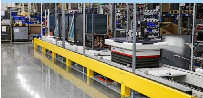
La « ligne d'évaporation » – cette section de transport comprend deux stations de travail sur lesquelles l'évaporateur est monté puis soudé.
