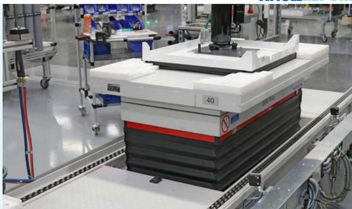
La plupart des postes de travail sont dotés d'une table élévatrice et d'une plateforme rotatrice permettant un montage ergonomique.
