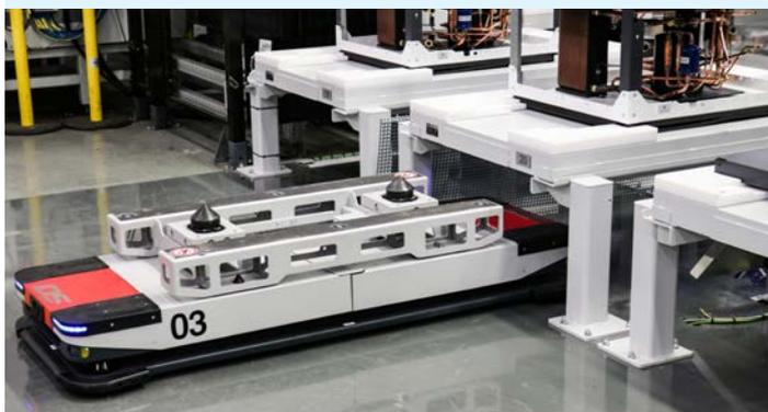
L'interconnexion de la technologie stationnaire de convoyage se fait au moyen de véhicules à guidage automatique. La gestion des ordres de transport a lieu dans la solution SAP ME pour laquelle tous les systèmes de l'installation ont une interface.
