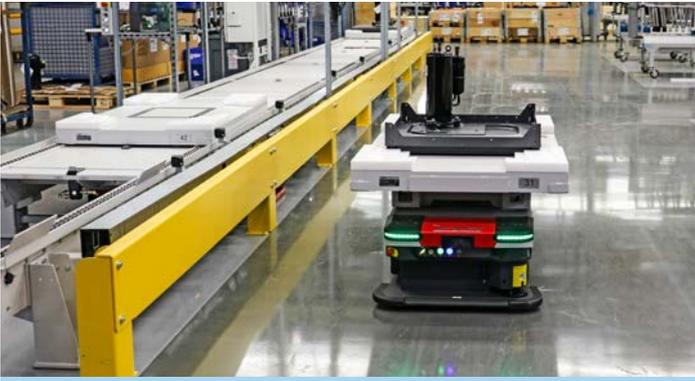
À gauche sur la photo : la première section de transport. Sur les deux postes de montage sont tout d'abord montés la plaque de fond puis le compresseur de chaque modèle de pompe à chaleur.
