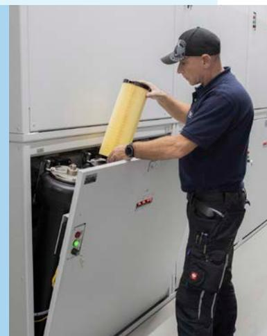
Il direttore delle manutenzioni Horst Anger dimostra quanto semplice risulta la sostituzione di una cartuccia filtrante.
