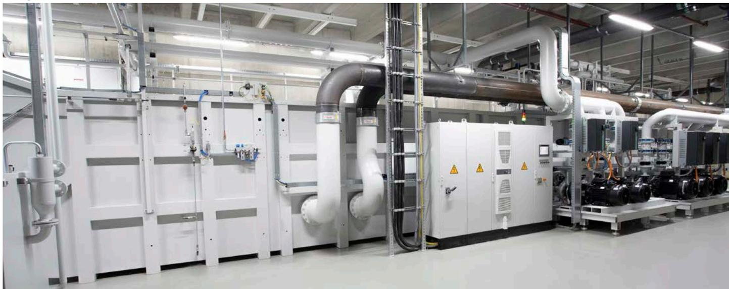
Convaincante grâce à la qualité élevée de l'huile de rectification, la température constante et les coûts modérés : l'installation centralisée de KNOLL se basant sur la technique de filtration MicroPur®. Dans la première phase d'installation, elle nettoie et met à disposition jusqu'à 6 000 l d'huile de rectification par minute. Dans la phase finale, ce sont 12 000 l/min.
