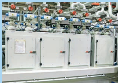
Quattro idrocicloni (racchiusi a causa della formazione di aerosol) forniscono le prestazioni essenziali del filtro. Sotto di esso si trova il trasportatore di raccolta dei fanghi dei cicloni e sopra di esso le tubazioni dei cicloni.
