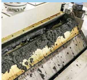
Una chiave del successo: pre-separazione tramite rulli magnetici.
