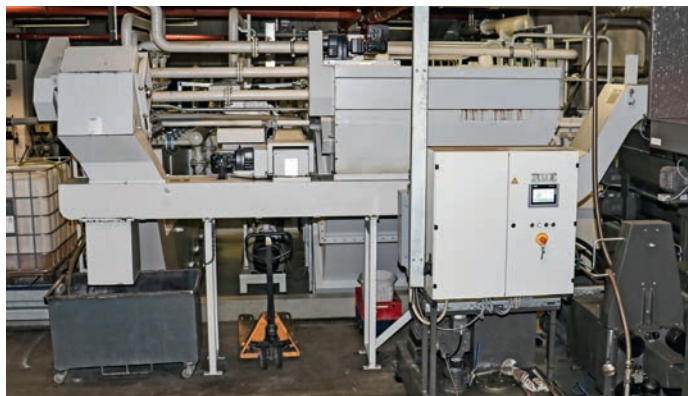
Dopo la pulizia, i fanghi di macinazione scaricati vengono pressati in pellet e il KSS recuperato viene riportato nel ciclo.
