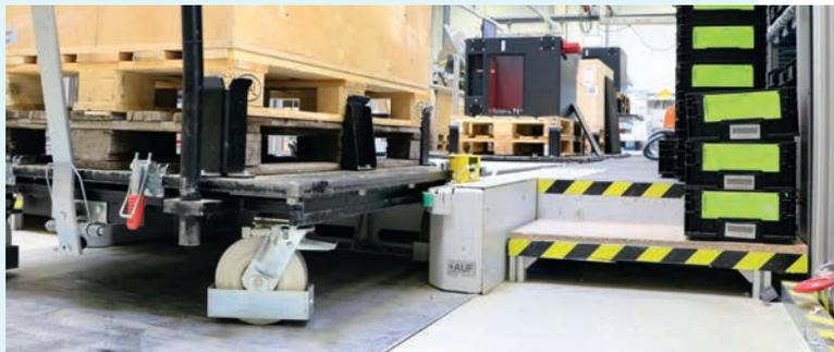
Gli alloggiamenti delle batterie da caricare sono disposti su un porta-pezzi a forma di piastra con una struttura prodotta in fabbrica, che a sua volta viene portata al nastro su un carrello di trasporto con rulli tramite un paranco o un manipolatore.
