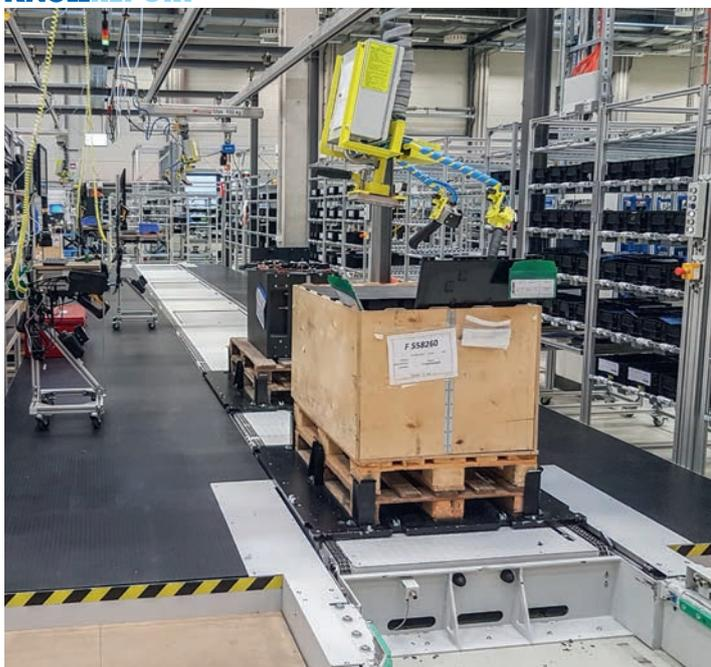
La BMZ monta batterie pesanti su sistemi di trasporto KNOLL del tipo TS-S e TS-G.
