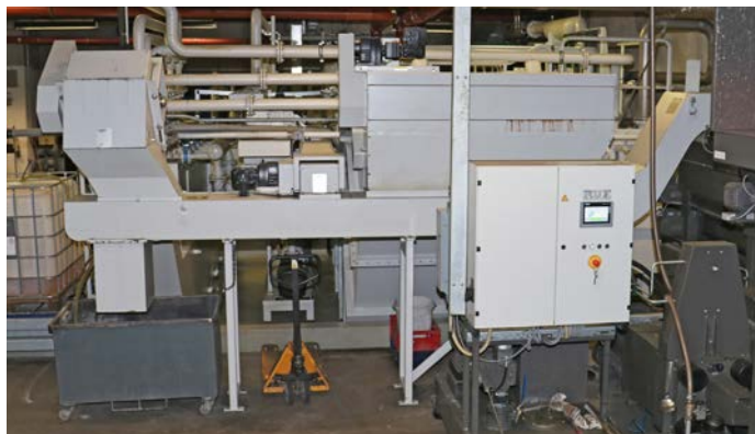
Nach der Reinigung wird der ausgetragene Schleifschlamm zu Pellets gepresst und der zurückgewonnene KSS dem Kreislauf wieder zugeführt.
