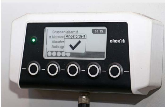
Einfach, robust und auch mit Handschuhen zu bedienen: Click.it Pro. Fünf frei programmierbare Tasten, ein Display und im Inneren ein Mikrocontroller, der mit dem Click.it-Server in Echtzeit kommuniziert – das eröffnet vielfältige Einsatzmöglichkeiten.
