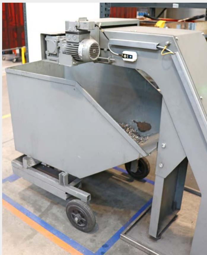
Ein Click.it One für den Spänewagen: Der angeschlossene Sensor meldet, wenn der Wagen voll ist und abgeholt werden muss. Parallel dazu hat der Maschinenbediener die Möglichkeit, den Vorgang per Knopfdruck auch schon früher zu beauftragen.
