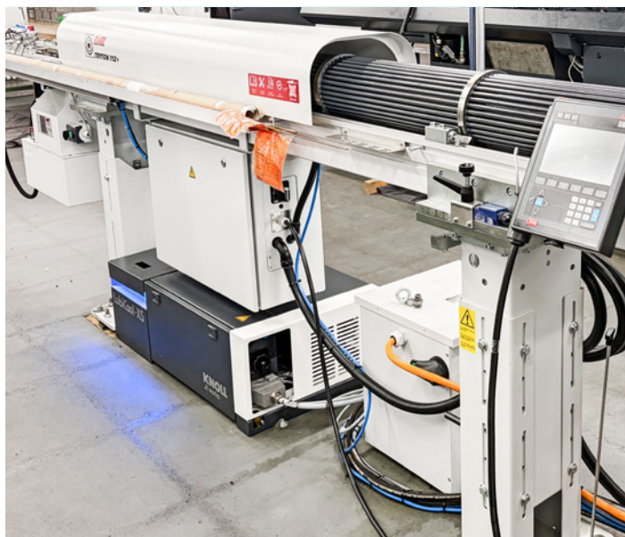
Le nouveau système haute pression KNOLL LubiCool®-XS s'intègre sans problème sous les ravivailleurs courants.
