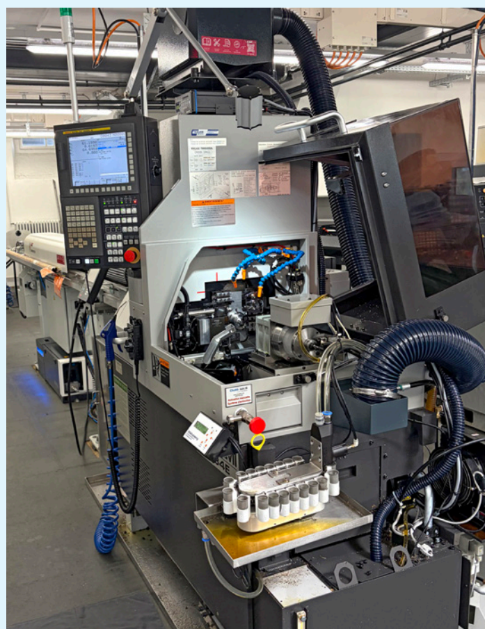
Le tour automatique à poupée mobile Tsugami P034WE est conçu pour la fabrication en série de pièces extrêmement petites et précises. L'alimentation en lubrifiant de refroidissement haute pression est assurée par le nouveau LubiCool®-XS de KNOLL.
