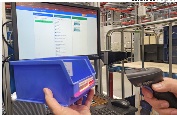
Click.it am Montageplatz bei LHY: Die Anwender greifen über Browser und angebundene Geräte wie Scanner auf die angebotenen Funktionen zu, zum Beispiel um Nachschub für eine leere Box anzufordern.
