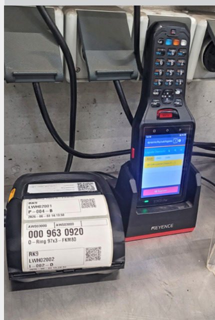
Nachdem die Anforderung in der Montage abgeschickt wurde, wirft der Drucker in der Logistik ein entsprechendes Etikett aus.
